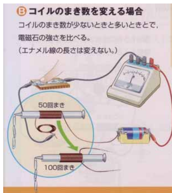
図3 電磁石の強さを調べる実験 (小学校理科教科書6年(平成14年版)より)
