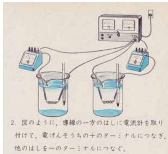
図6 太さの異なるニクロム線の発熱量を調べる実験 (小学校理科教科書5年(昭和46年版)より)
