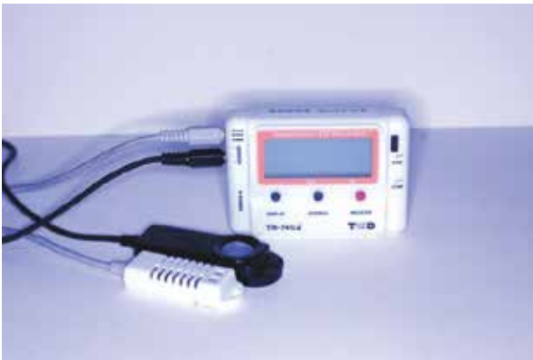
写真3 T&D社製 TR-74Ui 手前白いセンサー：温湿度 奥 黒いセンサー：照度・紫外線強度
