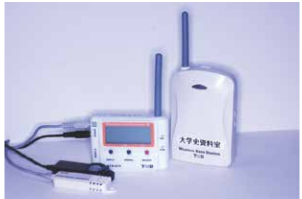
写真4 T&D社製 RTR-574 (データロガー・送信機) RTR-500C (受信機)
