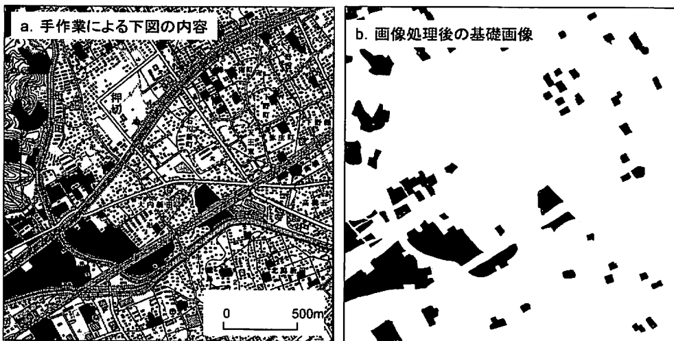
第1図 地形図からの基礎画像の作成 (1/2.5万地形図「清水」(平成13年発行))
