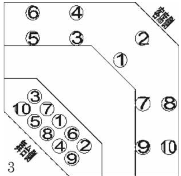
図3 発音、受音点の対応表。客席側に受音点、舞台側に発音点を設定し図のように番号を振った。
